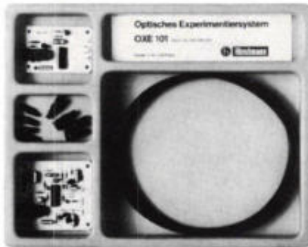
Afb. 2. Glasvezel-experimenteersysteem OXE 101 voor digitale optische verbindingen, van Hirschmann.
