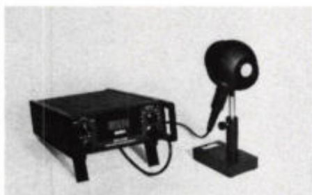
Fotometer/radiometer met integrerende bol.
