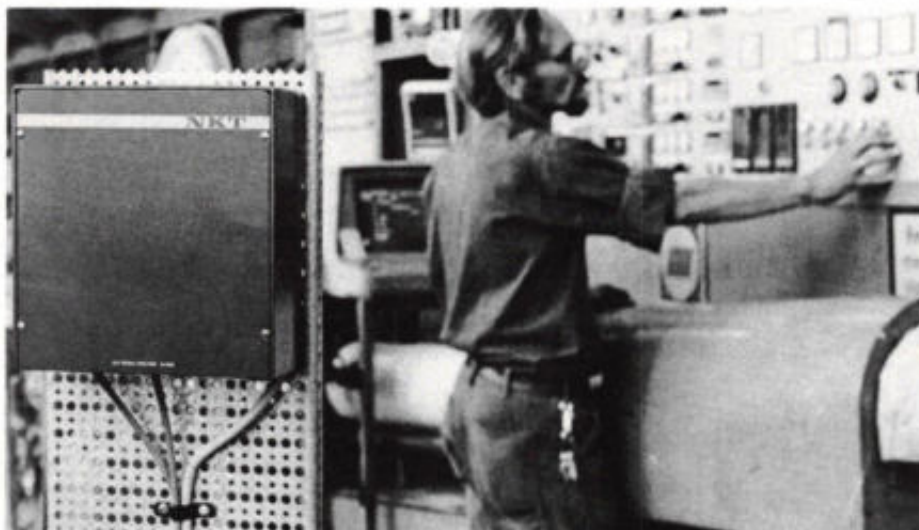
Afb. 3. Immuniteit voor elektromagnetische interferentie bij het besturen van industriële processen, is een van de gunstige eigenschappen van het door NKT geïntroduceerde PRONET-systeem. Dit glasvezel-ringnet kan tot 255 besturingseenheden (waarvan er op deze foto één is afgebeeld) omvatten.
