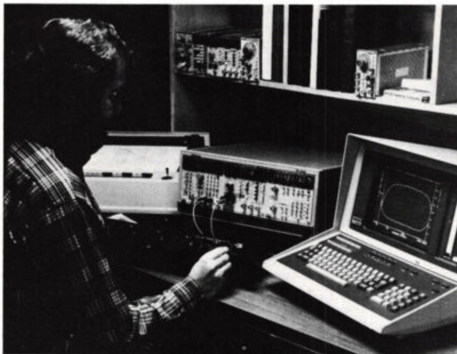
Automatisch audiomeetsysteem met de programmeerbare signaalgenerator SG5010 en de vervormingsanalysator AA5001 uit de modulaire TM5006-serie van Tektronix.
