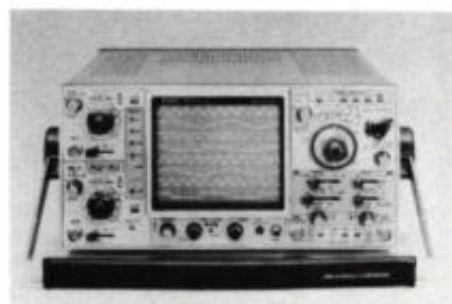
De CS2150 oscilloscoop met vier kanalen en acht sporen.
